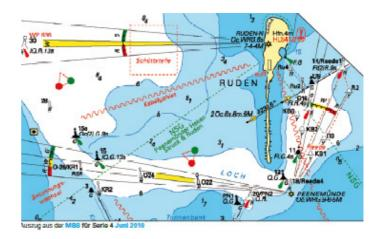
Der sichere Weg wird durch den weißen Sektor in der Mitte angegeben. Die Warnsektoren an den Seiten weisen darauf hin, dass eine Kursänderung erforderlich ist, um wieder in sicheres Fahrwasser zu gelangen. Dies erfolgt in der Praxis dadurch, dass man auf das Feuer zuhält und dabei die Farben der Sektoren im Blick hat. Dem Rechtsfahrgebot entsprechend sollte nicht die Mitte des weißen Leitsektors das ziel sein, sondern dessen rechter Rand.
